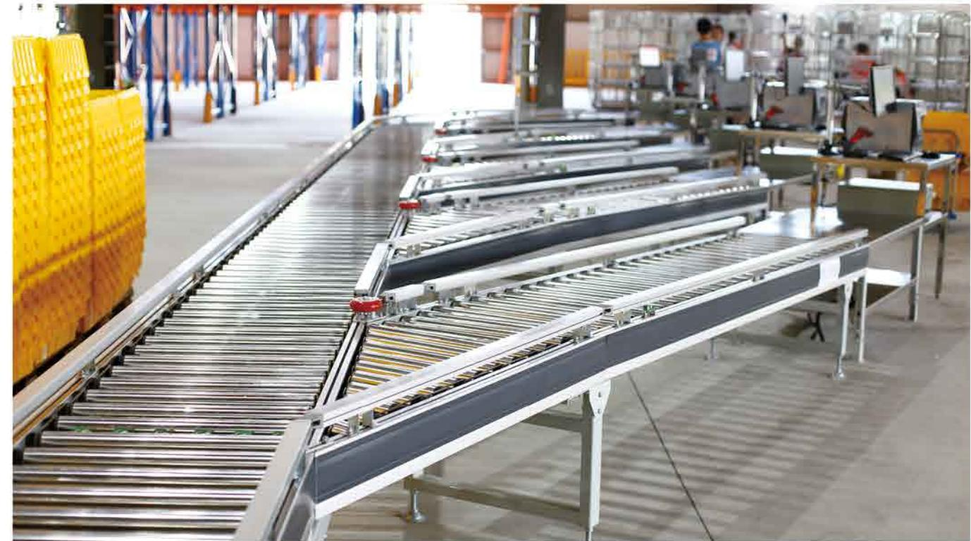
当WMS系统分配完成后，相关人员的手持中就会有货位货号的提示，经过优化，最终操作路径将会呈现在手持屏幕中，此时仓库在系统调动下开始加足马力运转，首先要保证货位在开动流水线后能实现即时装箱，叉车司机提前将货品由货架移至相关货位。在此过程中，包括智能流水线分拣系统、问题件处理、装箱及配送环节也都已全部启动。
